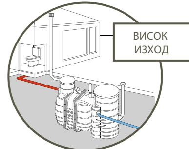
BIOROCK предлага като опция "високо ниво на заустване на пречистените води". Нашата система за заустване на високо ниво е оборудвана с надежден и висококачествен комплект помпи. Този комплект се доставя "предварително склобен" за по-лесен и бърз монтаж.
